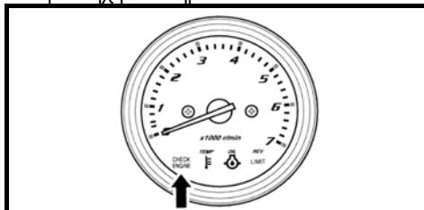
Το σύστημα αυτό επανέρχεται αυτόματα μόλις η τάση της μπαταρίας επανέλθει στο κανονικό επίπεδο. Στην περίπτωση που υπάρχει προειδοποίηση για χαμηλή τάση μπαταρίας, φροντίστε να αποφύγετε τη χρήση διαφόρων ηλεκτρικών εξαρτημάτων που σχετίζονται με τη μηχανή.
