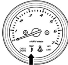
Αν το σύστημα προειδοποίησης υψηλής θερμοκρασίας ενεργοποιηθεί κατά τη διάρκεια της λειτουργίας, μειώστε αμέσως τις στροφές της μηχανής και ελέγχετε αν βγαίνει νερό από την οπή για τον έλεγχο του νερού της μηχανής. Αν δεν φαίνεται καθόλου νερό, ακολουθήστε τις διαδικασίες που περιγράφονται παρακάτω.
