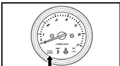
Επίσης έχει ενσωματωθεί ένα σύστημα αυτοπροστασίας, το οποίο επιτρέπει τη λειτουργία με περιορισμένες στροφές, ακόμα και σε τέτοια προβληματική κατάσταση.
