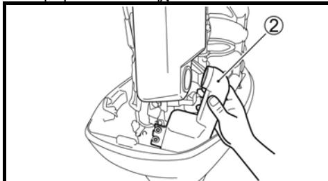
6. Τοποθετήστε ένα πανί κάτω από το φίλτρο πριν το αφαιρέσετε, για τυχόν διαροή καυσίμου.
